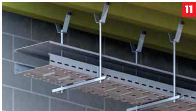
Montaža regala za trapezni plafon ostvaruje se pomoću nosača za trapezni lim, navojne šipke i nosača regala.
