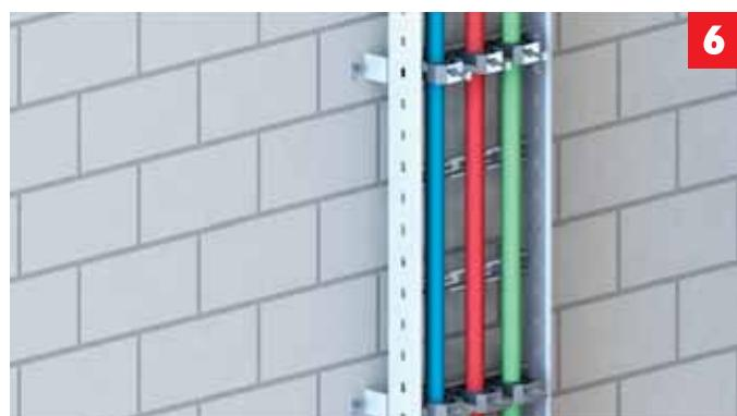
**Princip montaže lestvičastog regala na zid pomoću odstojnika vrši se pomoću torban vijaka tipa PEKOM M6 x12.**
